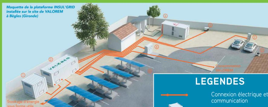
Installée depuis 2016 à Bègles en Gironde (siège de VALOREM), cette plateforme de test combine en temps réel une production multi-énergies renouvelables (solaire et éolien) et différents dispositifs de stockage (batteries lithium-ion, hydrogène) pour l'autoconsommation électrique de ses locaux et la mobilité électrique. Cette installation comprend un électrolyseur, un stockage d'hydrogène et une pile à combustible.
